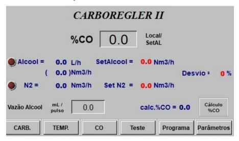
Nesta tela, dispomos da janela de entrada de dados para definir a quantidade equivalente em litros relativa a um pulso do transmissor de vazão de álcool.
