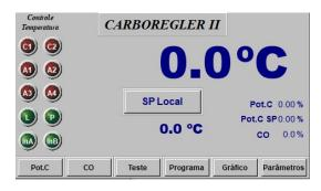
Inicialmente a malha de controle de Temperatura estará desativada. Isto pode ser verificado na respectiva Tela de controle e monitoração pela ausência dos elementos indicadores de saída de controle e da botoeira de seleção automático/manual, conforme figura ao lado.
